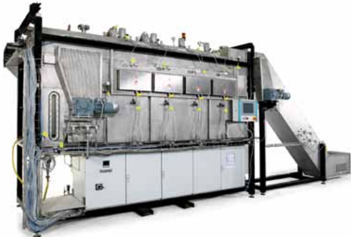
Die Trocknung stellt in vielen Industriebereichen einen wesentlichen Prozessschritt dar. Vorteile gegenüber der konventionellen Trocknung mit heißer Luft bietet das Trocknen mit überhitztem Dampf bei atmosphärischem Druck. Zusammen mit dem Fraunhofer IGB wurde dieses Trocknungsverfahren ständig weiterentwickelt und findet heute in zahlreichen Anlagen Einsatz.
