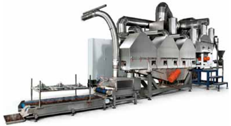
Diese Maschine macht es möglich: Anfang 2013 lies sich Heckmann das Verfahren der Kaffeeröstung mit Heißdampf patentieren.
